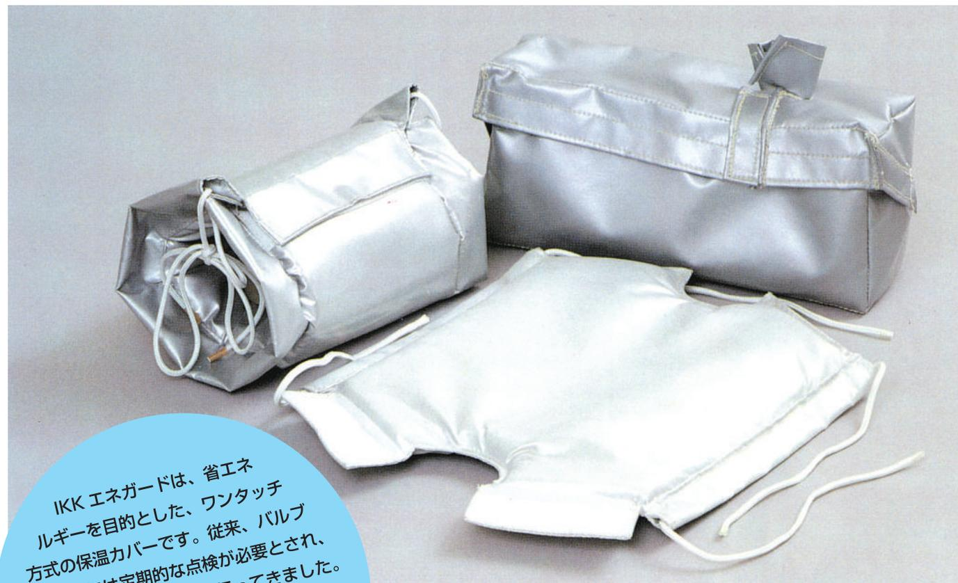
IKK エネガードは、省エネルギーを目的とした、ワンタッチ方式の保温カバーです。従来、バルブフランジには定期的な点検が必要とされ、その都度、解体、再施工を行って来ました。IKK エネガードは、保温材と外装材を一体化したもので、着脱が容易で、再施工を可能にし、工期の短縮にも貢献いたします。又、火傷防止の効果もあります。
